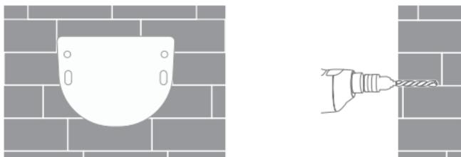
2. 将四个塑料膨胀螺母钉入墙壁后，设备上墙，底座贴于墙面上，并将螺钉穿入孔内，并拧入墙上的膨胀螺母中。
