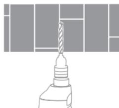
2. 将两个塑料膨胀螺母钉入墙壁，设备上墙，顶座贴于天花板上，并将螺钉穿入孔内，并拧入墙上的膨胀螺母中。
