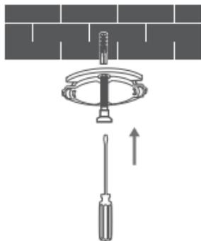
4. 将摄像机底部的凹槽对准基座上的凸起部分，按平后向任意一侧旋转直至锁定到位；
