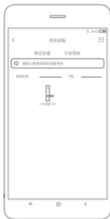
3. 找到小白智慧门H1后，点击图标，显示配对验证码，在门锁按键区输入配对验证码，点击面板上的“”，即可完成设备配对连接。
